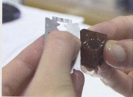
Fig. 2, 3. Tăierea probelor pentru obținerea secțiunilor subțiri ce vor fi analizate la microscop. Se vor alege cele mai bune secțiuni, adică, cele mai transparente și cele mai subțiri
