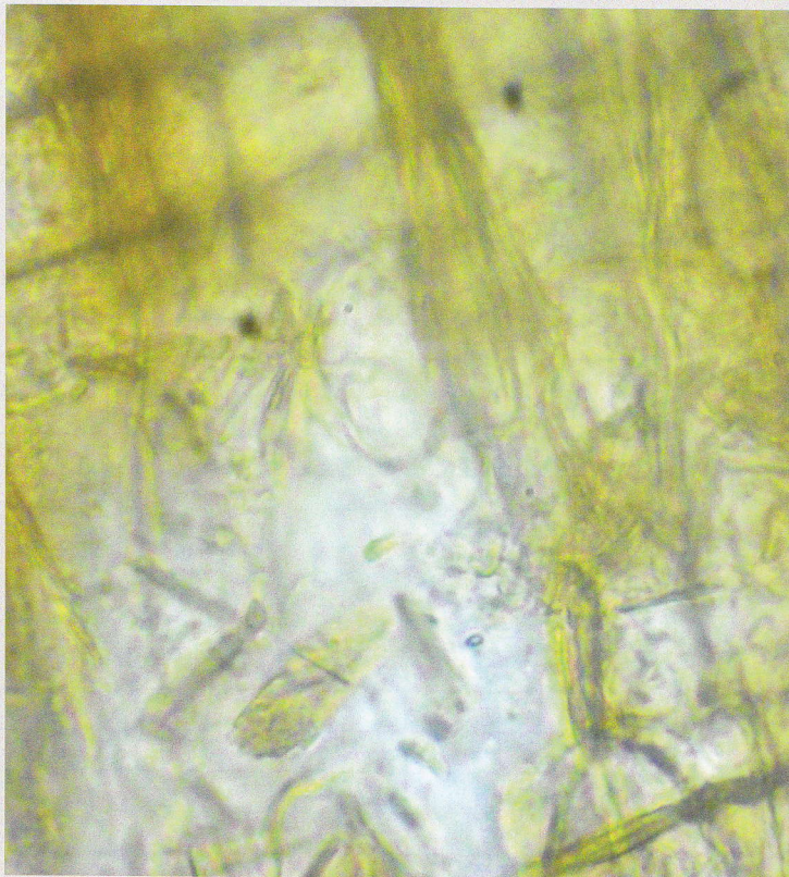
Fig. 8. Tunelurile formate de biodeteriogeni (posibil bacterii) sunt vizibile ȳn pereȳii celulari
