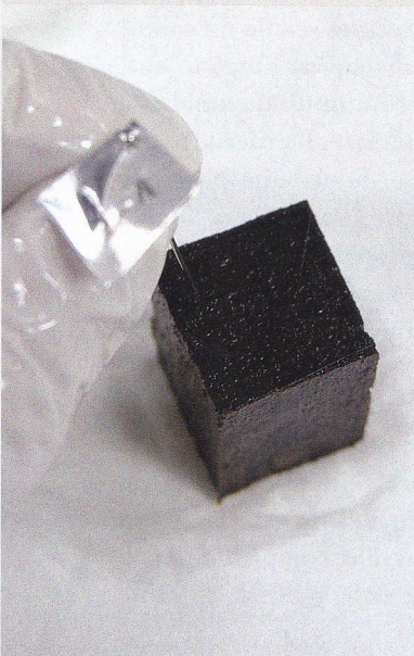
Fig. 10. Fixarea celor trei ace pe secțiunea transversală pentru a măsura contracția apărută în urma uscării
